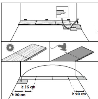
Несомненно, нам также придется распиливать некоторые панели. Для чистого распила панель должна располагаться декором вниз, если вы работаете ножовкой, и вверх, если пользуетесь электрическим лобзиком или циркулярной пилой. Во время укладки пола следите за тем, чтобы стыки панелей из двух соседних рядов не совпадали. Укладывайте панели таким образом, чтобы эти стыки располагались в шахматном порядке на расстоянии не менее 15 см друг от друга.
