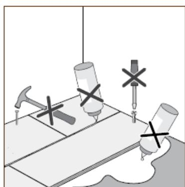
Uniclic® - революционная система, обеспечивающая возможность укладки напольных покрытий без использования клея. Панели напольного покрытия просто защелкиваются друг в друга благодаря оригинальной геометрии пары гребень-паз.
