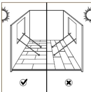
Укладку напольного покрытия желательно производить параллельно направлению падения света в данном помещении.
