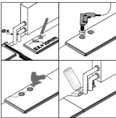
Схема укладки под радиатором батареи:
