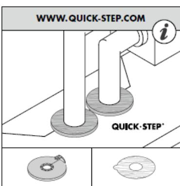
Для обеспечения идеальной отделки вокруг стояков используйте специальные розетки Quick-Step или заполните температурный шов эластичным герметиком.
