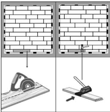
Между последним рядом планок и стеной также необходимо оставить температурный шов шириной 8-10 мм. Это необходимо учитывать при распиливании панелей последнего ряда. В тех местах, где укладывать планки Unilic® с помощью бруска для подшивки оказывается слишком трудно (например, у стены), вы можете сбивать их друг с другом при помощи молотка и монтажного ломтика.
