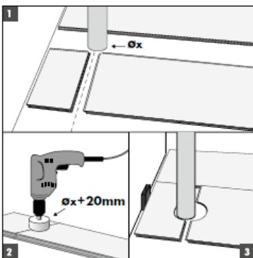
В тех рядах, где проходит стояк, необходимо обеспечить, чтобы он попадал точно на поперечный стык двух панелей. Возьмите коронку/сверло диаметром, большим диаметра стояка на 20 мм для обеспечения температурного шва. Защелкните панели друг в друга по короткой стороне и просверлите отверстие с центром на стыке между ними. Теперь вы можете уложить панели.
