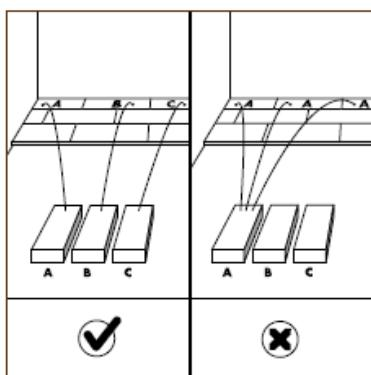
При укладке пола обязательно чередуйте между собой панели разных оттенков, из разных пачек, чтобы в конце вам не пришлось укладывать слишком много одинаково светлых или темных панелей подряд.
