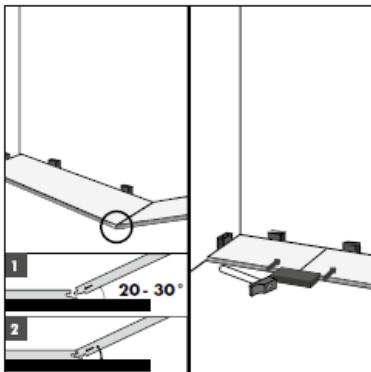
Поместите укладываемую панель под углом 20-30° к ранее установленной. Слегка подвигайте панелью вверх-вниз, одновременно надавливая на нее вперед. В результате панели автоматически защелкнутся в нужном положении. Для выравнивания панелей подстучите их в месте стыка, используя бруск Uniclic .
