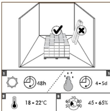
Обязательно дайте панелям возможность отлежаться в течение 48 часов в закрытой упаковке, расположив их в центре того помещения, где предполагается укладка напольного покрытия. Обязательным условием укладки является температура воздуха 15-20°C и относительная влажность воздуха в пределах 50-60%
