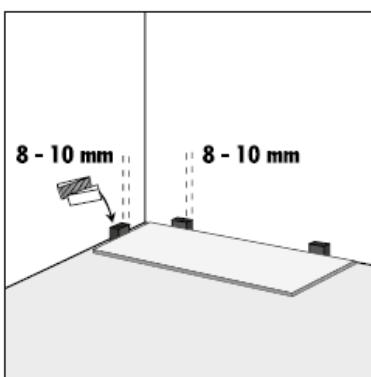
Расположите планку так, чтобы ее спиленные стороны оказались напротив стен. Установите между планками и стеной распорки из установочного комплекта. Это позволит обеспечить наличие температурного шва достаточной ширины: от 8 до 10 мм.
